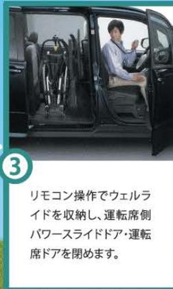
3 リモコン操作でウェルライドを収納し、運転席側パワースライドドア・運転席ドアを閉めます。
