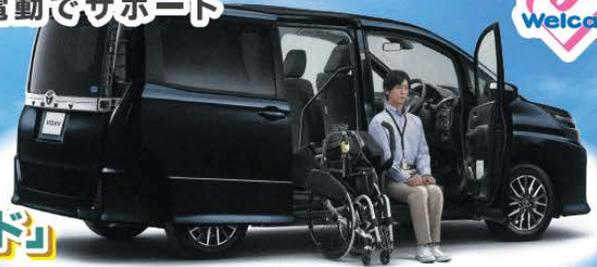
座面の高い運転席への移乗をサポートして、車いすの収納も一緒に電動で行えます。
